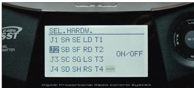
Ici, la sélection d'un organe de commutation se fait par sélection dans un tableau, et non par reconnaissance automatique d'un organe manœuvré par l'utilisateur (Futaba T8FG)
