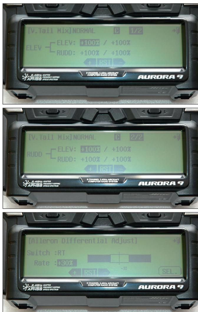
Voici l'exemple type d'une programmation explicite et trop détaillée : il ne faut pas moins de deux pages et huit valeurs pour définir un simple mixage de stabilisateur en Vé. Une troisième page est dédiée au réglage en vol du différentiel, ici avec le trim additionnel RT. (Hitec Aurora 9)
