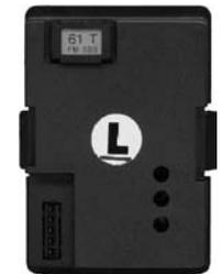
Module HF (Vu de l'arrière) avec un quartz *GRAUPNER* enfiché. Le quartz d'émission porte la désignation "T" (Transmitter).
