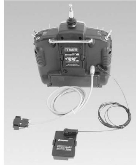
Cette illustration montre le raccordement du cordon d'interface et du cordon à conducteurs en fibre optique. L'autre extrémité de ce dernier est à raccorder sur le module Elève enfilé à la place du module HF dans l'émetteur Elève mx-22.
