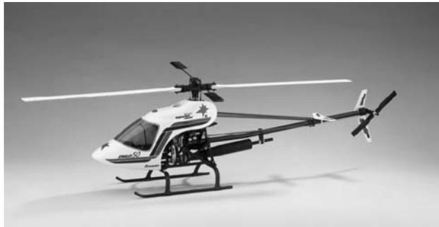
L'hélicoptère STARLET 50 de *GRAUPNER*, avec 3 points de connexion du plateau cyclique espacés de 120°, sans synchronisation avec l'augmentation de la courbe du Pas, sans réglage du gyroscope par l'émetteur et sans régulateur de régime servira d'exemple de programmation. Cet exemple simple a été choisi pour démontrer qu'il peut en résulter un hélicoptère volant impeccablement avec relativement peu de difficultés de programmation.
